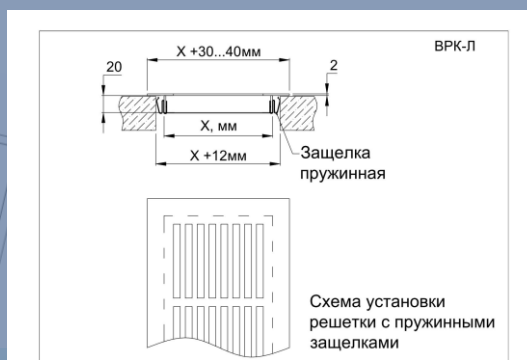
Принципиальная схема установки
