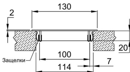
Крепление на пружинные защелки
