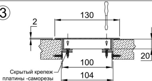
Крепление на скрытые пластины- уголки на саморезы
