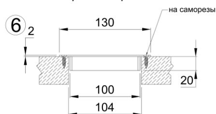
**Р**ешетки ВРК-Л- вентиляционные решетки конвекционного типа. Пригодны для установки как для естественной конвекции, так и для приточно-вытяжной вентиляции. Изготавливаются из холодно-катанной стали марки 08Пс и окрашиваются порошковой полиэфирной эмалью по Ral. Могут устанавливаться как конвекционные решетки, так и для приточно вытяжной вентиляции.
